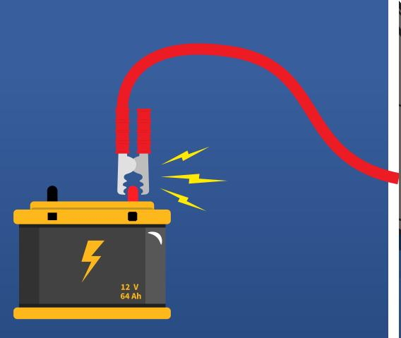
3. ATTACH THE RED JUMP LEAD TO THE POSITIVE TERMINAL
